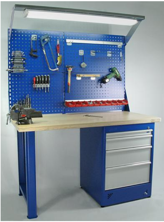
Przykładowa konfiguracja stanowiska z nadbudową i oświetleniem
